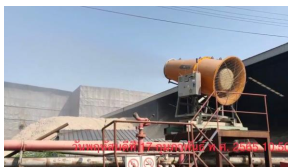
รูปที่ 10 การฉีดพรมน้ำกองกากอ้อย
