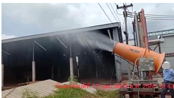
รูปที่ 10 การฉีดพรมน้ำกองกากอ้อย
